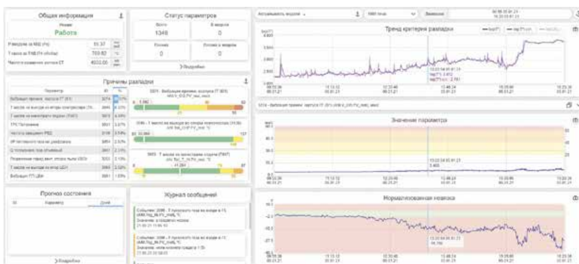
Пример работы статистической модели в условиях развития аномалии. Растущая вибрация, формально оставаясь в коридоре допустимых значений, тем не менее вызывает рост интегрального критерия состояния данного агрегата. В сочетании с остальными параметрами модели его поведение является нехарактерным и свидетельствует о наличии аномалии технического состояния.
